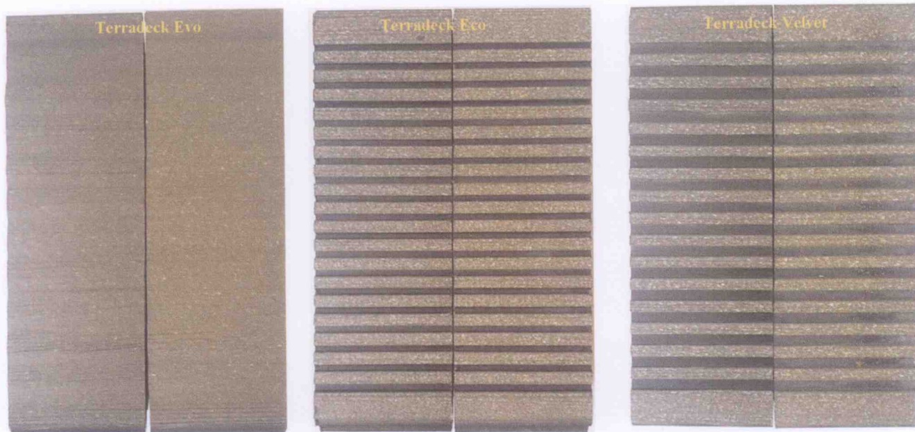
Фото образцов после выдержки в кипящей воде 2 часа
